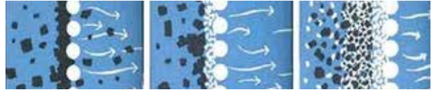
Resim 6: Perlitin filtre malzemesi olarak kullanımı
