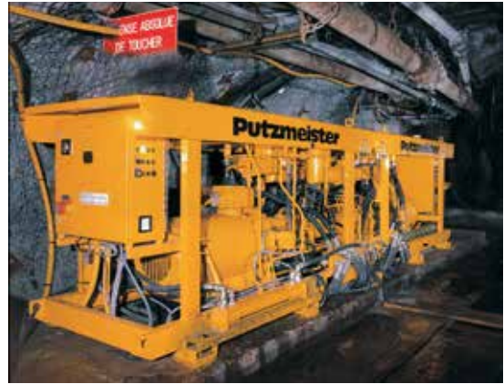
2 adet hidrolik ünite, HSP yüksek yoğunluklu katı pompasına gerekli güç performansı her biri 160 kW güç ile sağlamaktadır. Serbest akışlı hidrolikler, yüksek verimlilik sağlamaktadır.
