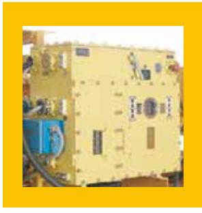
PLC EKLANLI EX-PROOF ELEKTRİK PANOSU
