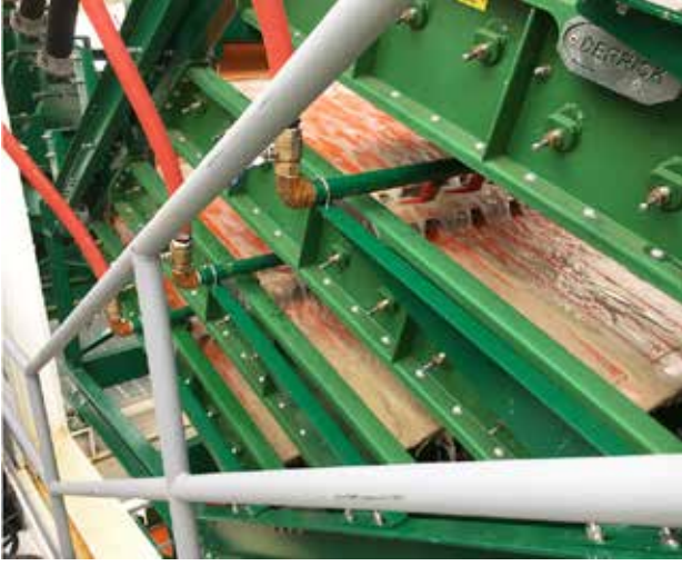
Şekil 3: Derrick Stacksizer Eleğindeki Spesifikasyonlara Uygun 420/210 Mikron Ürün
