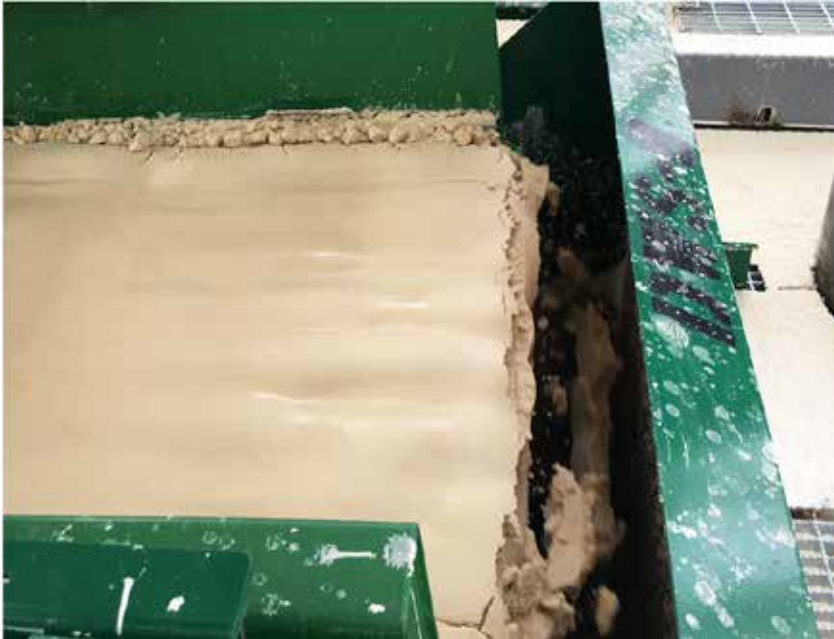
Şekil 4: Derrick Lineer Hareketli Susuzlandırma Eleğindeki Spesifikasyonlara Uygun 150 mikron Frac Kumu
